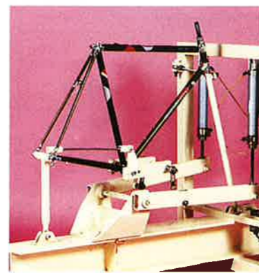
Machine à tester la durée de vie des cadres dans le centre d'études Look.
